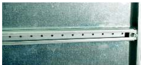
UPB - Usztywnienie Płyty Montażowej
